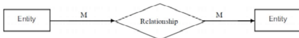
ภาพที่ 2.33 ความสัมพันธ์แบบ กลุ่ม -ต่อ-กลุ่ม (many-to-many)
